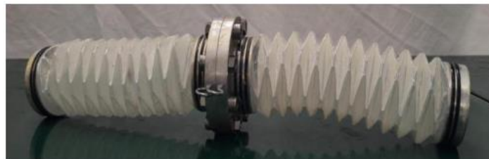
(d) Origami hydraulic damper set
