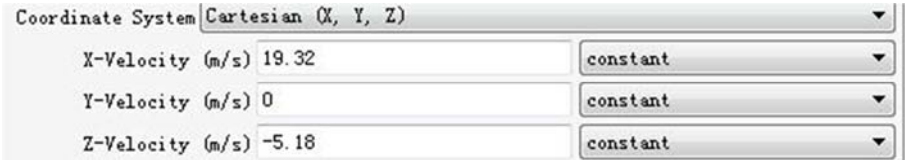
图14 通过速度坐标分量设置风速角。
