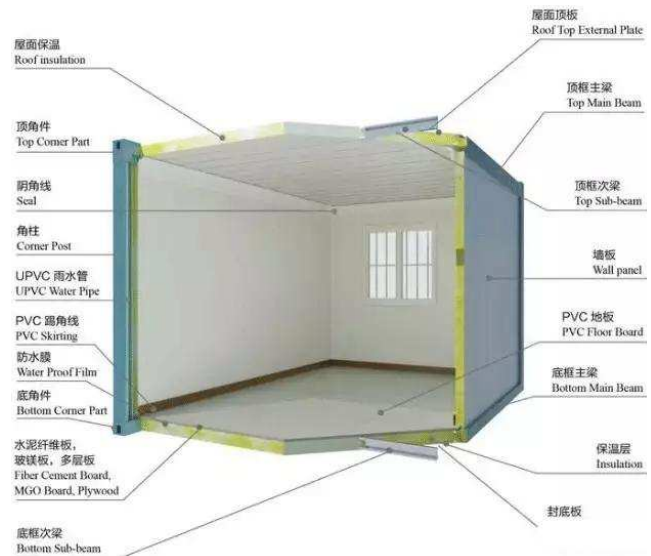
图9 模块打包箱构造图。
